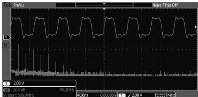
Анализ — Быстрое преобразование Фурье импульсных сигналов. Всеобъемлющий набор встроенных средств анализа ускоряет проверку характеристик разрабатываемого устройства.
