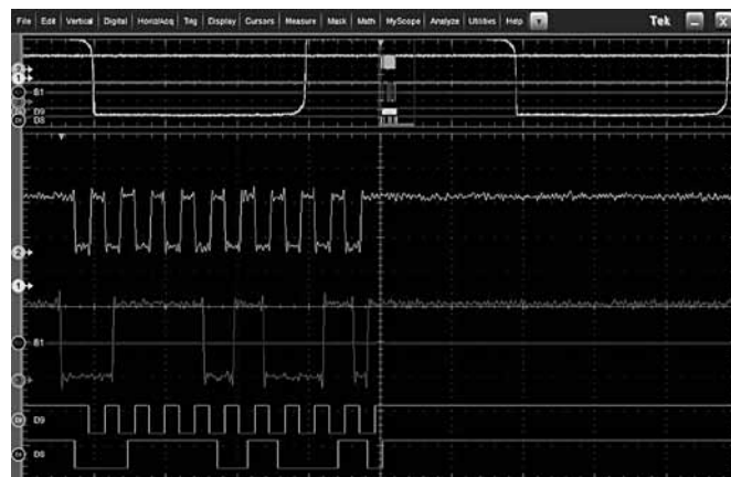
Привязанное к единой шкале времени отображение аналоговых и цифровых каналов для отладки системы.
