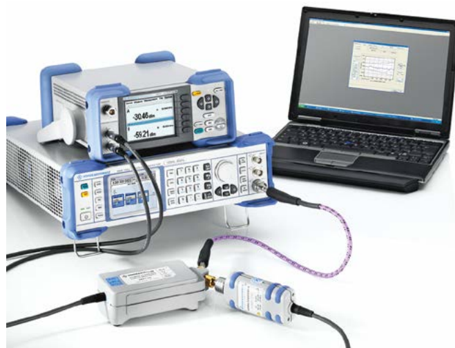
Измерительная установка для калибровки преобразователя мощности NRP-Z55
