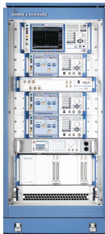
Пример конфигурации: трехканальная система для моноимпульсного радара
