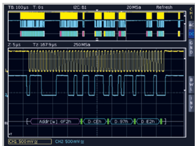
Шестнадцатеричное декодирование шины I 2 C по аналоговому каналу
